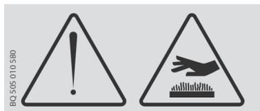
9. Questo adesivo è posto sul carter copricinghia trapezoidale sul lato del tubo di scarico motore e indica che vi è il rischio di ustionarsi.
